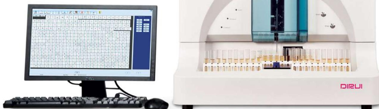
**FUS-2000 - это полностью автоматическая интегрируемая система анализа мочи, которая не только определяет физико-химические свойства и концентрацию частиц осадка мочи, но и делает реальные фотографии для последующего отображения каждого форменного элемента.**
